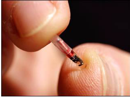
FIG. 6 – Ce tag est conçu pour être injecté sous la peau des animaux. Il est moulé dans un tube de verre de 1 à 3 cm. Source : Verichip
